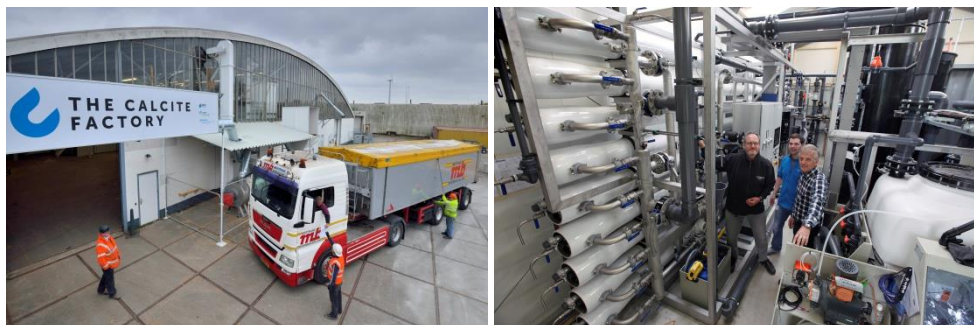
FOTO LINKS: THE CALCITE FACTORY; TERUGWINNEN VAN ENTMATERIAAL VOOR ONTHARDING, AMSTERDAM (MEDEWINNAAR IWA AWARD RESOURCE RECOVERY 2015) (BRON: WATERNET); FOTO RECHTS: PROEFHAL OASEN VOOR MULTI-SOURCE DRINKWATERZUIVERING, KAMERIK (BRON: OASEN)
